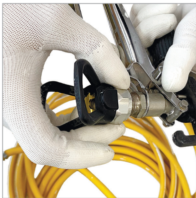
04 Перед закачуванням фарби у апарат необхідно зняти захисну насадку (соплотримач) з пістолета високого тиску
