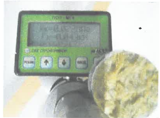
Рисунок 6 – Дослідний зразок № 99-3/21 при підготовці до випробування та типовий розрив
