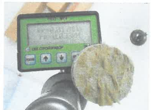
Рисунок 7 – Дослідний зразок № 100-3/21 при підготовці до випробування та типовий розрив
