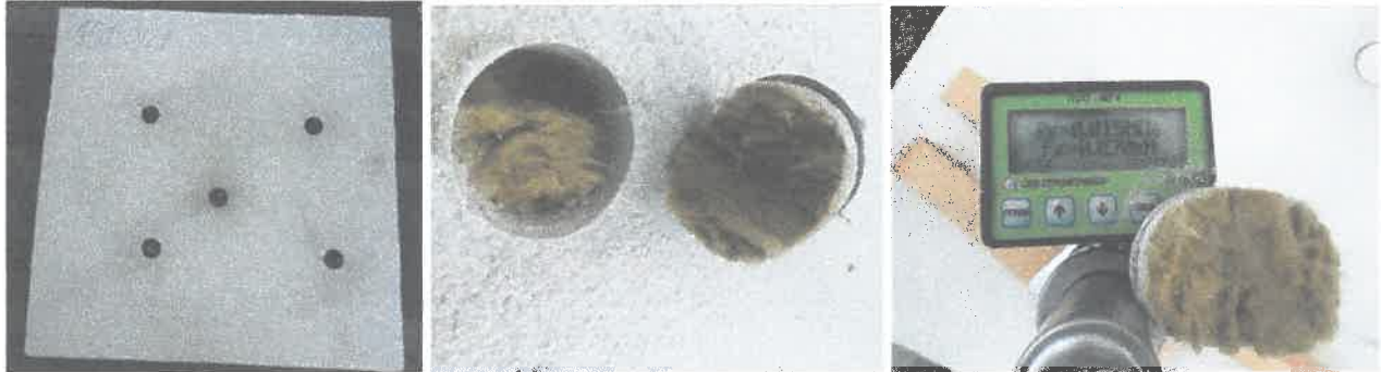
Рисунок 8 – Дослідний зразок № 101-3/21 при підготовці до випробування та типовий розрив
